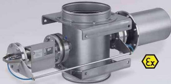
バルク材料は、センサーパイプを通過します。部分流体は光学測定システムに連続的に供給され、測定されます。光学系は汚れのつきにくい耐摩耗性ホウケイ酸ガラスにより保護されています。ページエア機能付き。
