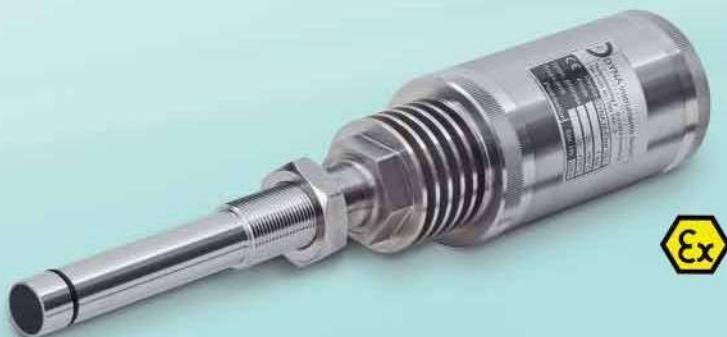
DYNA M-flowの測定原理はドップラー効果に基づいています。センサーはパイpline内に均一なマイクロ波場を生成し、センサーを通過する粒子はマイクロ波を反射します。反射波はデバイスによって受信され、周波数と振幅の変化を評価することで質量流量が決定されます。最大 24 種類の製品のパラメータを保存できます。
