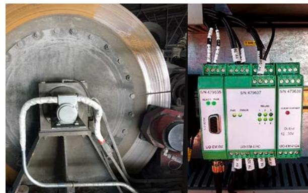
改善後、ダイレクトマウント型U-ONEエンコーダ (電子ユニットが制御盤込み) / After: Direct mounted U-ONE basic unit with electronic modules in the switchboard
