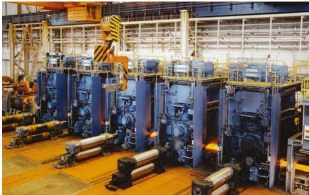
熱圧延型のロール圧延機
