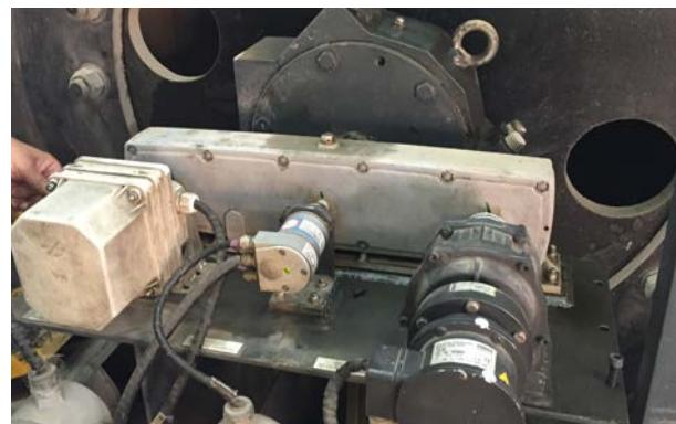
改善前：分配ギア (キャムスイッチ、絶対値エンコーダー、機械式過速度スイッチ付き) / Before: Distribution gear with mechanical cam limit switch, absolute encoder and mechanical overspeed switch
