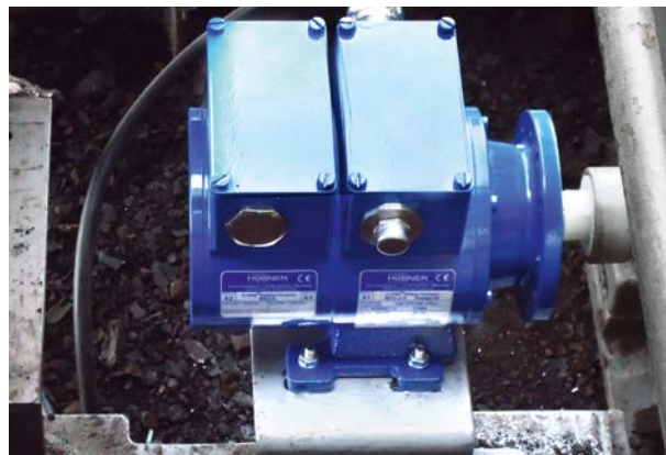
事後: 電子式位置スイッチERC 40。 After: Electronic position switch ERC 40.
