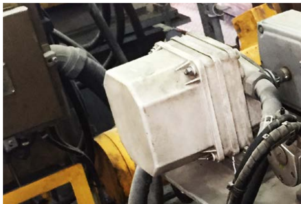
事前: 機械的ギア式カム・リミット・スイッチ。 Before: Mechanical cam limit switch.
