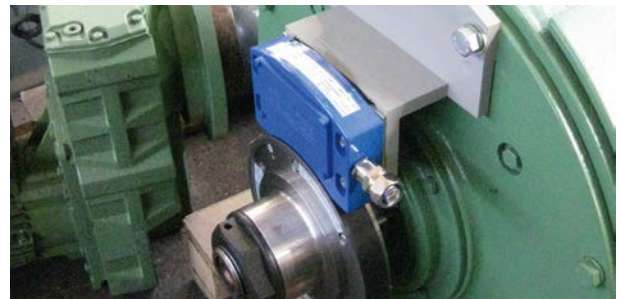
フリーベアリングMAGシステムは標準エンコーダーと比べて寿命が長くなっています。 The bearing-free MAG system has an extended lifetime compared to standard encoders
