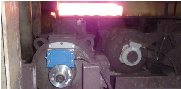
ローラーテーブルモーターは激しい衝撃と振動負荷にさらされます。 Roller table motors are exposed to high shock and vibration loads
