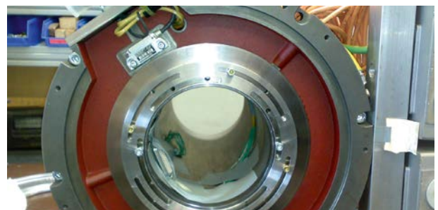
設置後: モーター収納ケース内のカスタマイズされたMAGシステムを直接組み立てたことにより、精密な信号 After: Precise signals through direct mounting of the customized MAG system in the motor housing
